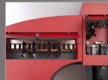
B2: Предварительно выровненные держатели нижнего инструмента Центровочные штифты позволяют замену на любой другой стандартный держатель инструментов Haeger без проверки выравнивания
