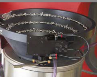
A: MAS 350 – Новая модульная система автоматической подачи
