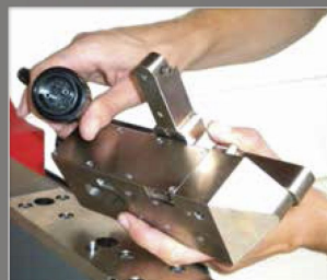
B2: Предварительно выровненные держатели нижнего инструмента Центровочные штифты позволяют замену на любой другой стандартный держатель инструментов Haeger без проверки выравнивания
