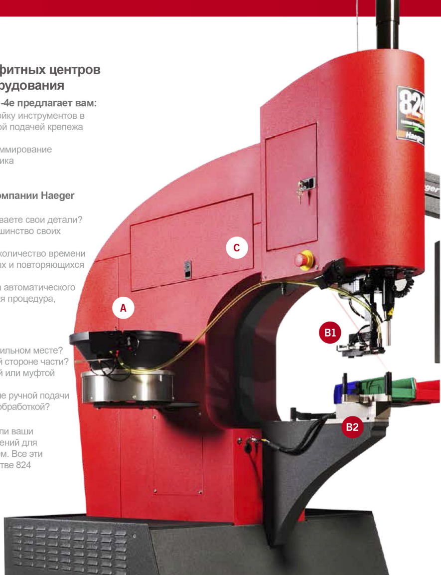
B1: Новая Т-скоба и челнок со встроенными соединительными соединителями, исключающими необходимость перенастройки
